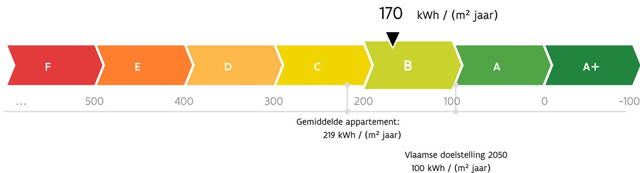
De energiescore en het energielabel van dit appartement zijn bepaald via een theoretische berekening op basis van de bestaande toestand van het gebouw. Er wordt geen rekening gehouden met het gedrag en het werkelijke energieverbruik van de (vorige) bewoners. Hoe lager de energiescore, hoe beter.
