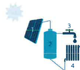
1. Zonnecollector | 2. Opslagvat zonnecollector 3. Sanitair warm water 4. Afgifteenheid voor ruimteverwarming (radiator)
