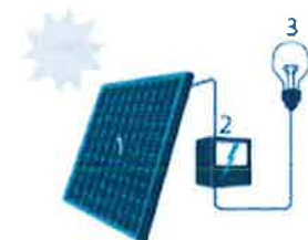
1. Zonnepaneel | 2. Omvormer 3. Elektrische aansluiting
