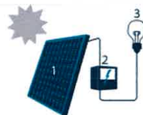
1. Zonnepaneel | 2. Omvormer 3. Elektrische toestellen
