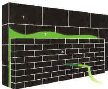
1. Dragende muur | 2. Ingeblazen isolatie | 3. Gevelsteen / gevelbekleding
